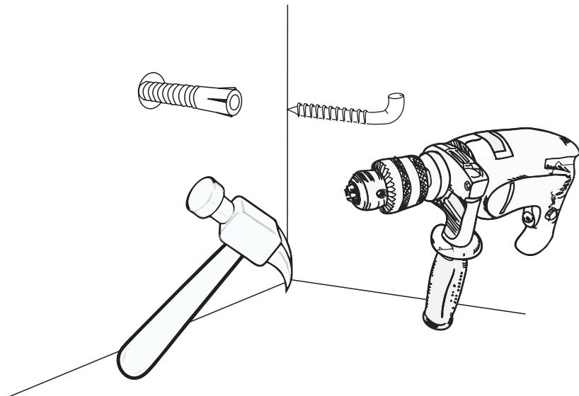
**ВНИМАНИЕ!** В комплектацию входит дюбель, предназначенный только для бетонной и кирпичной стен. Для гипсокартонной стены дюбеля подобрать самостоятельно, а так же заложить усиленный каркас для правильного распределения нагрузки изделия.
